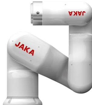
JAKA 協働ロボットの全シリーズは、革新的にロボットマニピュレータをモバイルスマート端末と APP による制御モードを採用し、1 台のモバイル端末で複数のロボットマニピュレータを制御することができます。同時に、オペレーターは専門的なプログラミング言語を習得する必要がなく、ロボットを手動でガイドするだけでプログラミングが完了するため、人とロボットの協働がより快適になり、作業の効率が大幅に向上させられます。
